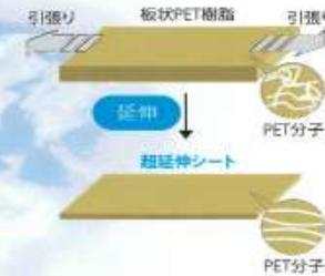
●PET分子が引っ張った方向に並ぶ事で強固な鎖の役割を果たし高強度なシートになります。熱処理を行い結晶化させることで熱が掛かっても縮まなくなり耐熱性も確保。『超芯LEVOL』の強さの秘密は超延伸シートにあります。
